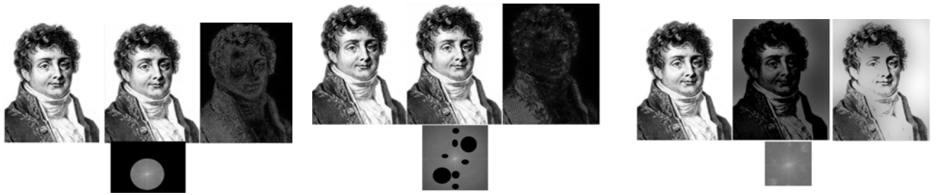
Figura 6: Imagens do Fourier com aplicação de filtro para frequências baixas, ruídos e altas. A primeira usa um filtro que bloqueia as frequências baixas no plano de fourier, o segundo retira o ruído nos 4 quadrantes e a terceira retira apenas o centro, deixando passar frequências médias e baixas. As imagens apresentadas são a original, a filtrada e uma menos a outra. Figuras geradas no ImageJ com o uso da FFT.
