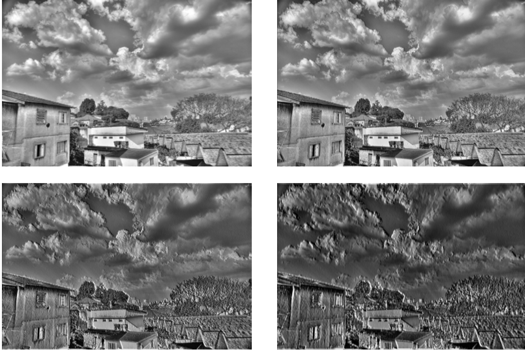
Figura 5: Resultados do gradiente aplicado à figura usada na média, com N igual a 3, 9 e 17. O aumento do comprimento das matrizes de convolução fazem com que sejam destacados trechos mais homogêneos com relação às derivadas vertical e horizontal, selecionando contornos de objetos maiores na imagem.
